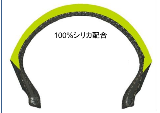
(図 6) フロントタイヤのコンパウンド シリカ配合率
